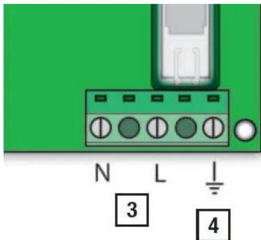
3. 230 V Netzspannung
