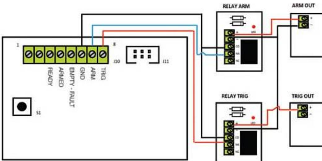
Der EIN/AUS-Ausgang dieses Alarmpanels ist ein offenes Relais, wenn das Panel ausgeschaltet ist, das während der gesamten Überwachungszeit des Alarmpanels kontinuierlich geschlossen bleibt. Der Alarmausgang des Panels ist ein offener Realy, der schließt, wenn ein Alarmzustand erkannt wird.
