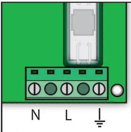
Beim Anschluss der Maschine an das Stromnetz wird empfohlen, auf den Anschluss und das Anziehen der Schrauben der Klemmleiste zu achten. Das Trennen oder Modifizieren des Erdungskabels führt zum Erlöschen der Garantie und kann zu Problemen oder Unfällen im Zusammenhang mit der Temperaturregelung führen.
