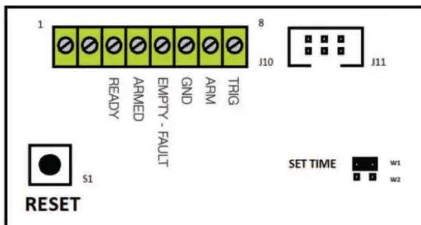
Um die Aufnahmezeit einzustellen, müssen Sie nach dem Öffnen der Frontplatte den Jumper W1 wie in der Abbildung gezeigt in SET-Position schließen, dann bei gedrückter Taste S1 „RESET“ die grüne LED auf der Vorderseite blinken und jeder Blitz ist gleichwertig auf eine Sekunde. Wenn Sie die Taste erneut drücken, wird die Aufnahmezeit nicht zu der zuvor eingestellten hinzugefügt, sondern beginnt wieder bei Null.
