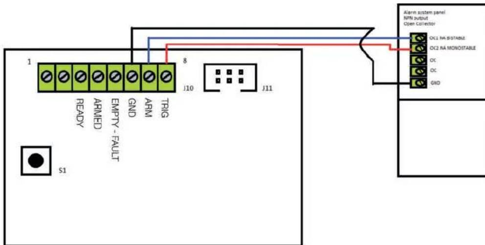
Der EIN/AUS-Ausgang dieses Alarmpanels ist ein Open-Collector-NPN, der bei ausgeschaltetem Alarm OFFEN ist und während der gesamten Zeit, in der das Alarmpanel aktiv ist und überwacht, nahe an negativ ist. Der Ausgang der Alarmzentrale ist normalerweise offen und schließt den Kontakt während der Alarmzeit.
